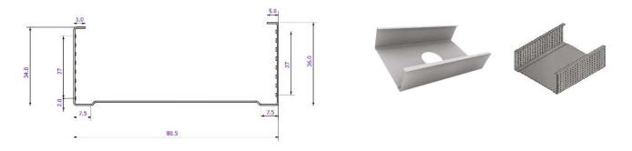
Ossatures métalliques pour plaques de plâtre
